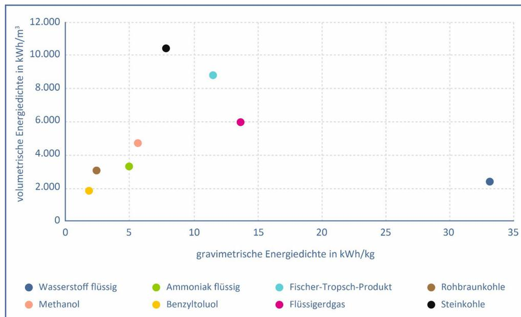
Abbildung 20: Energiedichten der per Schiff transportierten Stoffe und fossiler Vergleichsprodukte
